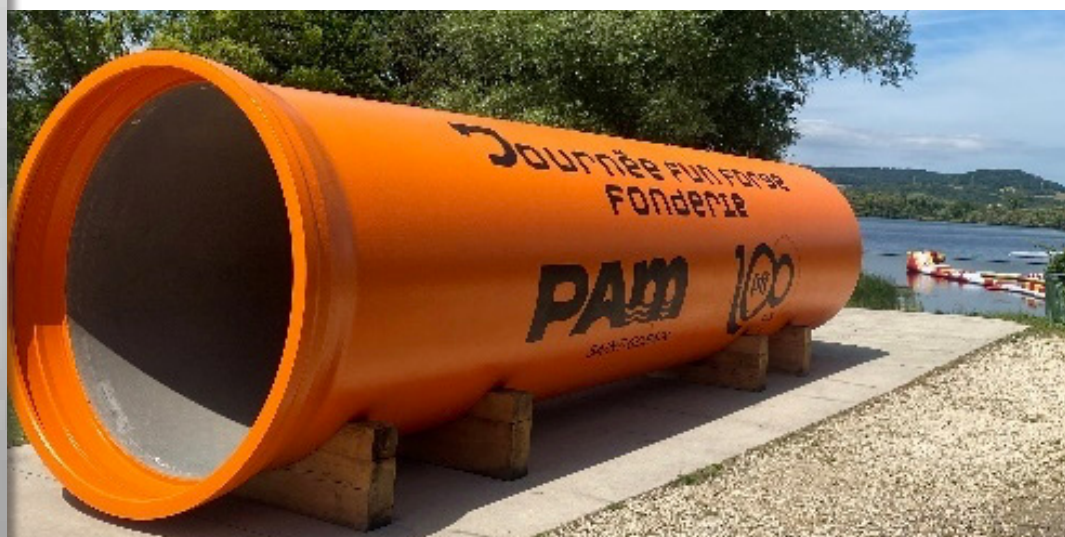
Ce tuyau (2m X 8m) a été fabriqué par Saint-Gobain PAM Canalisation par le procédé de centrifugation.
